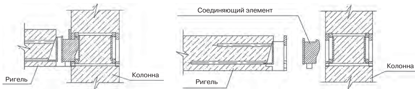
Рис. 9. Схема узла сопряжения ригеля с колонной Fig. 9. Diagram of the crossbar-column interface
