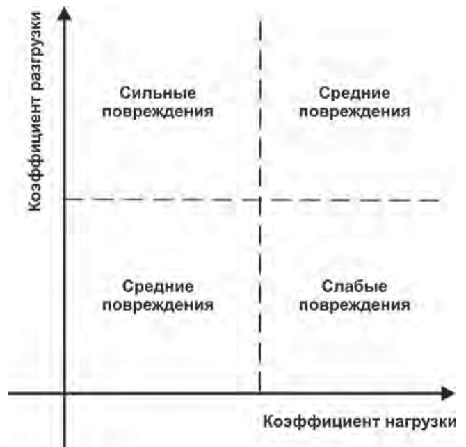
Рис. 3. Оценка степени повреждения железобетонных балок на основании коэффициента нагрузки L и коэффициента разгрузки CR
